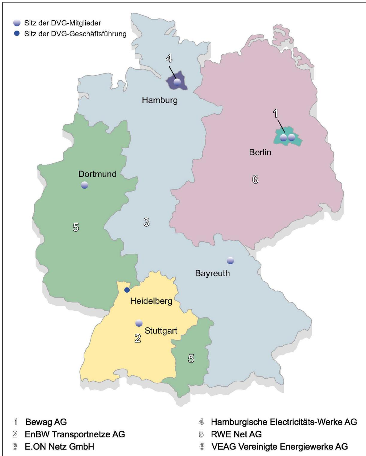
Bild 4.6: Regelzonen der Übertragungsnetzbetreiber in Deutschland. Quelle: [DVG02]
